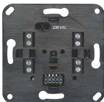
Schrauben Sie die UP-Einheit des BTR 55 mit den beiliegenden PT-Schrauben in die UP-Dose. Nachdem die UP-Einheit montiert ist, werden der Rahmen und die mitgelieferte Frontplatte aufgesteckt.
