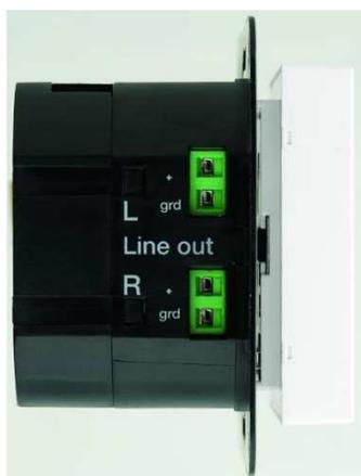
Schließen Sie den Line-Out Ausgang bei Bedarf an Ihre Audioanlage an. Stecken Sie dazu das Kabel in die Klemmen und schrauben es mit den an der Frontseite zugänglichen Schrauben fest.
