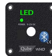
! Sobald der Qube BT eingeschaltet ist, springt er automatisch in den Pairing-Mode.
