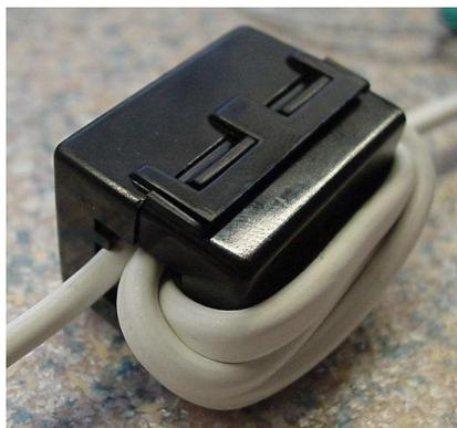
Den Ferritkern so nah wie möglich (max 10 cm) an der primären Anschlussleitung (230V) anbringen. Hierbei wird das Anschlusskabel mindestens vier Mal durch den Kern gewickelt.
