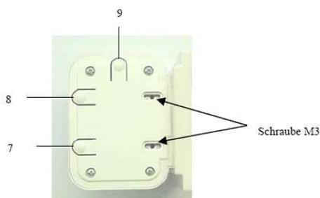
Lösen Sie die beiden M3-Schrauben auf der Unterseite der Ladeschale.
