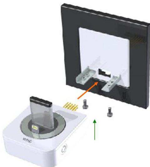
Schieben Sie die MP 55 BTL Ladeschale vorsichtig in die montierte UP-Einheit des MP 55.
