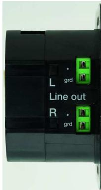
Schließen Sie den Line-Out Ausgang bei Bedarf an Ihre Audioanlage an. Stecken Sie dazu das Kabel in die Klemmen und schrauben es mit den an der Frontseite zugänglichen Schrauben fest.
