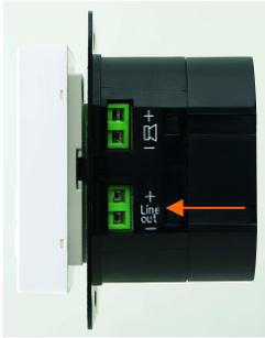
Verwenden Sie ein abgeschirmtes Kabel. Legen Sie den Schirm auf (-) und den Innenleiter auf (+) auf und ziehen Sie die an der Frontseite zugänglichen Schrauben fest.
