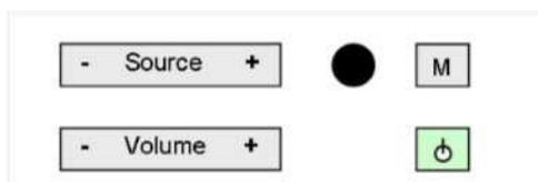
Drücken Sie den **ON/OFF** Knopf rechts unten auf dem Bedienfeld. Das Gerät schaltet sich ein.
