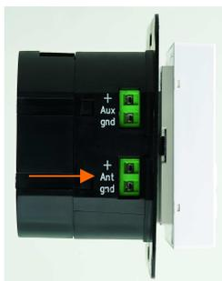
Anschluss eines Koax Antennenkabels:
