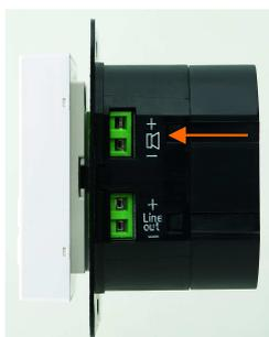
Schließen Sie die Lautsprecher an die dafür vorgesehenen Klemmen an. Stecken Sie dazu das Kabel in die Klemmen und schrauben Sie es mit den an der Frontseite zugänglichen Schrauben fest.
