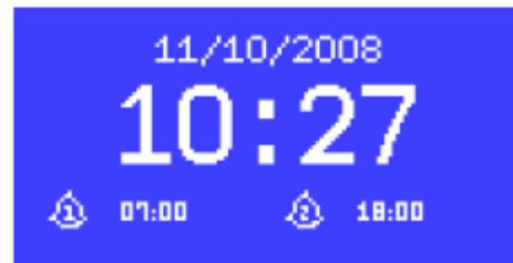
Die Bildschirmdarstellung **Splash** zeigt die unterschiedlichen Betriebsarten an und wird über den Drehregler (Mode) gesteuert. Nach einer Sekunde bei Verbleib auf einer Auswahl springt das Gerät in diese Auswahl und startet mit der zuletzt gefundenen Einstellung. Falls keine Einstellung gefunden wird, scant das Gerät automatisch nach verfügbaren Sendern oder meldet eine Eingabeaufforderung.
