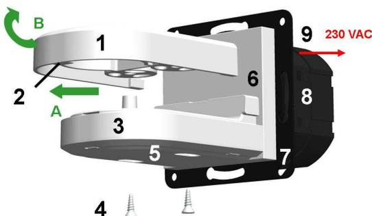
Reinigen Sie das Gerät in regelmäßigen Abständen. Nehmen Sie dazu den Deckel (1) der Ladevorrichtung ab. Ziehen Sie den Deckel (1) leicht nach vorne (A), damit Fixierschluss (2) gelöst ist und kippen es dann sanft nach oben weg (B).
