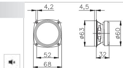
Kompaktes Einbauchassis mit hohem Wirkungsgrad und großer Bandbreite.
