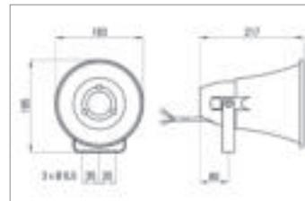
Kleiner, preiswerter Druckkammerlautsprecher mit hohem Wirkungsgrad für Sprachdurchsagen und zur Alarmierung im Innen- und Außenbereich, z.B. in Produktionsstätten, Tiefgaragen, .... Der TL 310 ist mit einem herkömmlichen Treiber bestückt. Daraus resultiert ein hoher Wirkungsgrad. Die Montage erfolgt über einen im Lieferumfang beinhalteten U-Bügel. Er kann auch mit der optionalen Mastbefestigung MB 1/2 an einem Masten befestigt werden.
