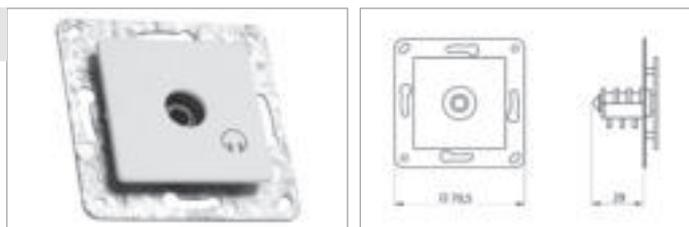
Kopfhörerbuchse. Bei eingestecktem Kopfhörer (6,3mm Stereo-Klinke) werden die Lautsprecher dieser Hörzone stummgeschaltet. Der Anschluss erfolgt am DAM IR-Tastmodul. Das DAM HP wird mit einer bedruckten 50 mm-Zentralplatte in Farbe reinweiß matt ausgeliefert und passt mit im Elektro-Fachgroßhandel erhältlichen Adapterrahmen zu nahezu allen gängigen Schalterprogrammen.
