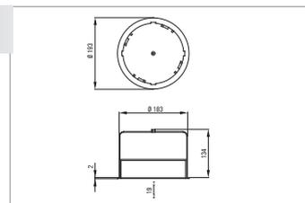
Eingießtopf aus Kunststoff, mit Putzausgleichsring, für Betondecken, passend für den Einbau-Lautsprecher UP 14 und UP 14/2.
