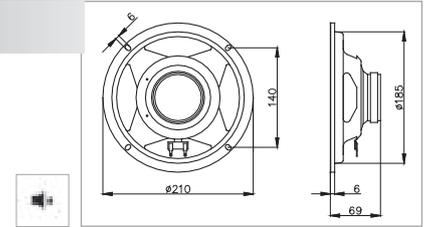
Chassis mit leichter, steifer Membrane mit niedriger Eigenresonanz. Dies ergibt einen hohen Wirkungsgrad und eine gute Basswiedergabe.
