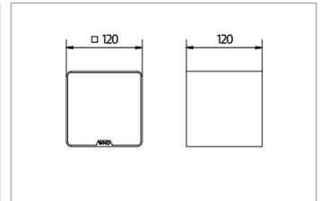
Der Qube BT ist ein HiFi-Lautsprecher mit eingebautem Bluetooth-Empfänger und Verstärker. Das hochwertige Aluminiumgehäuse ist in schwarz oder weiß lackiert und mit einer Stoffabdeckung bestückt. Der Qube BT empfängt die Musik per AirPlay\*, DLNA oder UPnP. Sonderfarben auf Anfrage.
