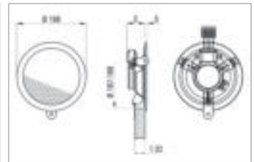
Standard-Deckenlautsprecher mit besonders flacher Bauform (5 mm), ideal geeignet für die Wiedergabe von Sprache und Hintergrundmusik in höheren Räumen (3...4 m) z.B. Kaufhäusern, ... Akustisch überzeugt der UPM 200 mit einem wirkungsstarken 135 mm-Breitbandchassis mit zusätzlichem Hochtonkegel. Weitere Features sind: Erdungsschraube und Zugentlastung. Mit einer einzigartigen Federmechanik erfolgt der Deckeneinbau sekundenschnell.
