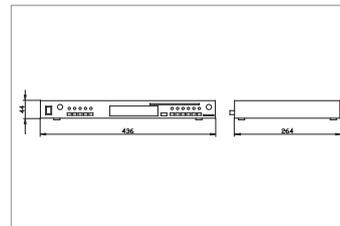
Der CT 101 vereint RDS-Radio, SD-, USB- und CD-Player mit mp3 Datenerkennung in einem Gerät. Er ist optimal geeignet als universelle Audioquelle mit einem zusätzlichen AUX-Eingang für die Multiroomsysteme DAM 6000 V3, DAM 4000 Basic und KNX-Audio sowie für die Verstärker AMP 120 und AMP 550.
