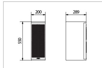
2-Wege Beschallungsbox mit höchster Wiedergabetreue. Geschlossenes System für besonders präzise Basswiedergabe. Einsetzbar in hochwertigen Festinstallationen, in denen es nicht nur darauf ankommt, dass man gerade einmal etwas versteht, sondern dass das Zuhören Spaß macht. Die Box ist mit Stativhalterung, Flugbefestigung bestückt und mit Strukturlack beschichtet. Das Gehäuse ist aus stabilem Birkenmultiplex.
