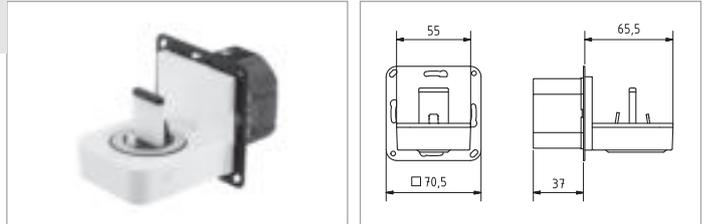
Der MP 55 BTL ist eine hochwertige Ladestation mit integriertem Bluetooth-Receiver, Stereoverstärker und 230V-Netzteil für iPod/iPhone und beliebige andere Smartphones.
