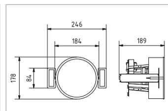
Für Anwendungen, bei denen hochwertiger Sound mit möglichst unauffälliger Optik kombiniert werden soll, ist der FL 180 R die perfekte Lösung. Der FL 180 R ist ein rahmenloser Lautsprecher mit High-End Breitbandchassis, der bündig in Gipskartondecken eingeputzt wird. Die Lochblechabdeckung ist leicht nach hinten versetzt, so dass sich der Lautsprecher nahezu unsichtbar in die Decke integriert.
