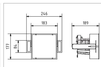
Für Anwendungen, bei denen hochwertiger Sound mit möglichst unauffälliger Optik kombiniert werden soll, ist der FL 180 Q die perfekte Lösung. Der FL 180 Q ist ein rahmenloser Lautsprecher mit High-End Breitbandchassis, der bündig in Gipskartondecken eingeputzt wird. Die Lochblechabdeckung ist leicht nach hinten versetzt, so dass sich der Lautsprecher nahezu unsichtbar in die Decke integriert.
