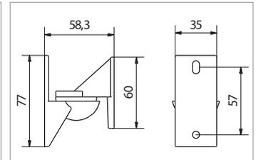
Kugelgelenk-Halterung aus Kunststoff, passend für die kompakte HiFi-Box QB 200 und den WLAN-Lautsprecher Qube.
