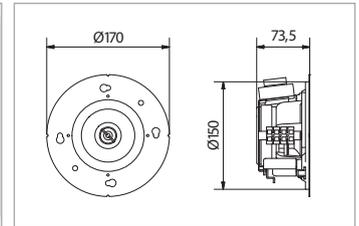
2-Wege Koaxial-Deckenlautsprecher mit Kevlarmembrane und Seiden-Ringradiator im Hochtton.
