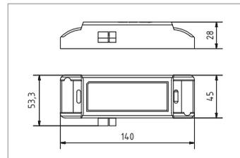
Das BTR 205-Radio ist ein leistungsfähiger Bluetooth-Empfänger mit Stereoverstärker, Radio und 230V-Netzteil in einem kompakten Gehäuse zum Einbau in Hohlräume wie Decken, Wände, Möbel, hinter Spiegeln, ... Die Bedienung des Radios erfolgt über die im Lieferumfang enthaltene Fernbedienung. In Verbindung mit WHD-Lautsprechern perfekt geeignet zur Hintergrundbeschallung u.a. in Küchen, Bädern und Hotelzimmern etc.
