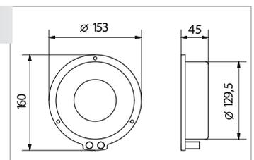
Der BS 200 wird rückseitig auf Materialien wie Holz, Spiegel etc. befestigt, regt diese zum Schwingen an und verwandelt sie in einen unsichtbaren, erstaunlich gut klingenden Subwoofer. Ideal geeignet zur Baßunterstützung der Exciter/Körperschallwandler X 32.
