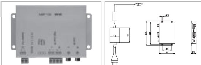
Der AMP 130 ist ein Verstärker zur Erweiterung zum HiFi-System. Er wird z.B. in Decken oder Wände eingebaut und bietet die Möglichkeit 2 Lautsprecher anzuschließen, um in einem größeren Wohnraum Musik in höherer Lautstärke und HiFi-Qualität wiederzugeben.
