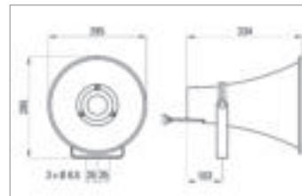
Preiswerter, großer Druckkammerlautsprecher mit sehr hohem Wirkungsgrad für Sprachdurchsagen und zur Alarmierung im Innen- und Außenbereich, z.B. in Produktionsstätten, Tiefgaragen, .... Der TL 330 ist mit einem herkömmlichen Treiber bestückt. Daraus resultiert ein hoher Wirkungsgrad. Die Montage erfolgt über einen im Lieferumfang beinhalteten U-Bügel. Er kann auch mit der optionalen Mastbefestigung MB 1/2 an einem Masten befestigt werden.
