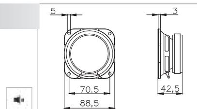
PM 87-8 M: Kompaktes Einbauchassis mit sehr hohem Wirkungsgrad. Besonders geeignet für den Einbau in Tonsäulen.
