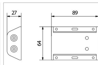
Der HL 401 ist ein High-Level-Converter und ermöglicht die Signalanpassung eines niederohmigen Lautsprecher-Ausgang an ein Line-In Signal. Die galvanische Trennung sorgt dabei für eine störungsfreie Anbindung.
