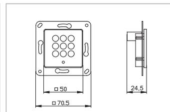
Unterputzfernbedienung für HLS 51 Radio Basic und Radio BTR 205.
