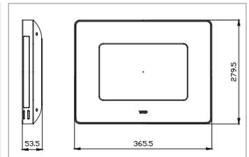
Das SOUNDPAD für das Apple iPad Air und Air 2 kombiniert Soundsystem, Dockingstation, Touchpanel und Video-/Foto-Display in einem stylischen Gehäuse. Es wird einfach auf der Wand installiert und ans Stromnetz angeschlossen. Starke Elektromotoren ziehen das iPad sanft ein und werfen es auf Knopfdruck wieder aus. Clever: Für hochformatige Anwendungen kann das SOUNDPAD einfach um 90° gedreht werden.
