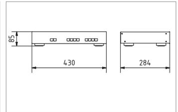
Erweiterungsmodul für die DAM 4000 Basic zum Anschluß von 8 Bedieneinheiten DAM Basic IR in strukturierter Verkabelung zur Zentrale.
