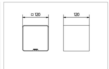
Der Qube BT 2 go ist ein HiFi-Lautsprecher mit eingebautem Bluetooth-Audioempfänger, Verstärker und Akku. Das hochwertige Aluminiumgehäuse ist in schwarz oder weiß lackiert und mit einer Stoffabdeckung bestückt.
