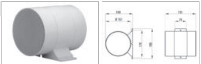
Doppelabstrahl-Lautsprecher zur Beschallung von langen, schmalen Räumen wie z.B. Flure und Treppenhäuser. Dieser Lautsprecher ist mit zwei 135 mm-Breitbandchassis mit zusätzlichen Hochtonkegeln bestückt. Sie sind gegenphasig angeschlossen, wodurch sich in erster Linie 90 Grad zur Hauptabstrahlrichtung Auslöschungen bilden und somit eine keulenförmige Abstrahlcharakteristik entsteht. Die Montage erfolgt mittels zwei Schrauben.
