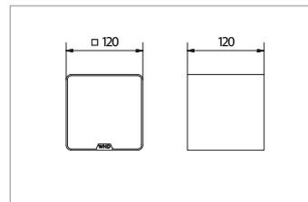
Der Qube 2 go ist ein HiFi-Lautsprecher mit eingebautem WLAN-Audioempfänger (IEEE 802.11n/WPA2), Verstärker und Akku. Das hochwertige Aluminiumgehäuse ist in schwarz oder weiß lackiert und mit einer Stoffabdeckung bestückt. Der Qube 2 go empfängt die Musik per AirPlay\*, DLNA oder UPnP. Sonderfarben auf Anfrage.
