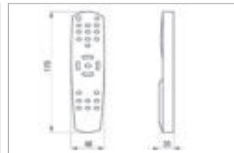
Preiswerte Infrarotfernbedienung für das DAM-System mit allen wichtigen Funktionen incl. Tonquellensteuerung. In jeder Zentraleinheit DAM 6000 ist eine Fernbedienung RC 6000 enthalten.
