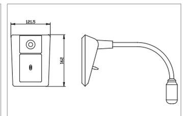
Die Mikrofonsprechstelle MIC 100 ist optimal für den Betrieb mit den Verstärkern AMP 120 und AMP 550 geeignet.
