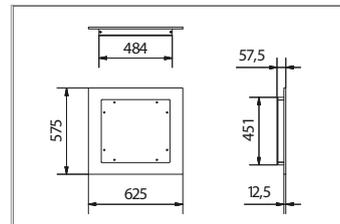
Der Wavebreaker ist ein hervorragender, unsichtbarer Flächenlautsprecher. Das Besondere an ihm ist sein Aufbau, seine Materialien und seine Abmessungen. Die Front besteht aus dünnem Gipskarton, der optimal gestrichen, verputzt und sogar übertapeziert werden kann. Darunter folgt ein Sandwichtaufbau aus verschiedensten Materialien.
