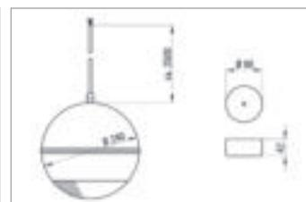
2-Wege HiFi-Kugellautsprecher für den gehobenen Anspruch, ideal geeignet für die Wiedergabe von Hintergrundmusik in z.B. Raststätten, Foyers, ... (Montagehöhe 3...5 m). Der KL 1603/2 ist mit einem 166 mm-Tieftonchassis und einem coaxial angeordneten Hochtöner bestückt. Er wird über eine am Kabel befestigte Zugentlastung an die Decke gehängt. Ein Baldachin verdeckt die Aufhängung und sorgt für ein harmonisches Erscheinungsbild.
