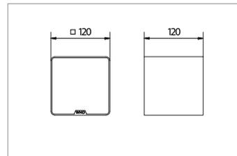
Der Qube L ist ein HiFi-Lautsprecher mit eingebautem LAN-Anschluss (RJ 45) und Verstärker. Das hochwertige Aluminiumgehäuse ist in schwarz oder weiß lackiert und mit einer Stoffabdeckung bestückt. Der Qube L empfängt die Musik per AirPlay\*, DLNA oder UPnP und kann über die Ethernetbuchse oder per WLAN betrieben werden. Sonderfarben auf Anfrage.
