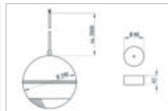
Standard-Kugellautsprecher mit hohem Wirkungsgrad, ideal geeignet für die Wiedergabe von Sprache und Hintergrundmusik in z.B. Baumärkten, Markthallen, ... (Montagehöhe 3...5 m). Er ist mit einem 166 mm-Breitbandchassis bestückt. Der KL 1603 wird über eine am Kabel befestigte Zugentlastung an die Decke gehängt. Ein Baldachin verdeckt die Aufhängung und sorgt für ein harmonisches Erscheinungsbild.
