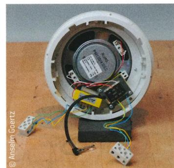
Chassis mit doppelter Schwingspule, zwei Übertrager, Keramikklappen und ein Fangseil
