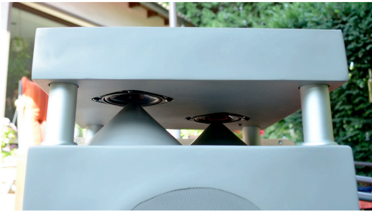
Im oberen Teil des GL 100 sitzen die Breitbandlautsprecher, unten logischerweise die Tieftöner.
