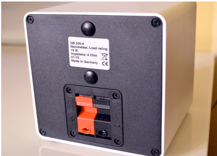
Dank simpler Druckklemmen sind die Lautsprecherkabel schnell an ihrem Platz. Ansonsten ist auf der Rückseite der QB 200 nichts zu sehen.
