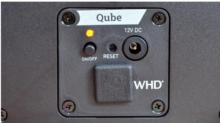
Um den Qube2Go in einem anderen WLAN einzubinden, lässt er sich per Reset-Knopf zurücksetzen.
