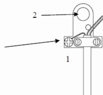
4. Baldachin bis an die Decke hochschieben und mittels Stelling befestigen.
